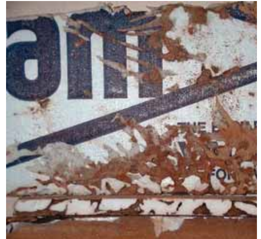
Fig. 14. Un ejemplo de aislamiento con "foam-board" lleno de galerías de termitas. (B. T. Forschler)
